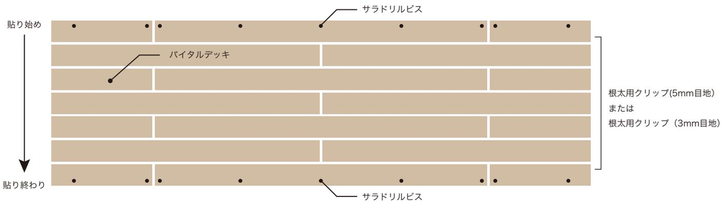
※デッキ材を長手方向に沿ってカットした場合、スタート用クリップ、エンド用クリップを使用することはできません。長手方向に沿ってカットした場合は、サラドリルビスを使用して脳天からビス止めをしてください。
